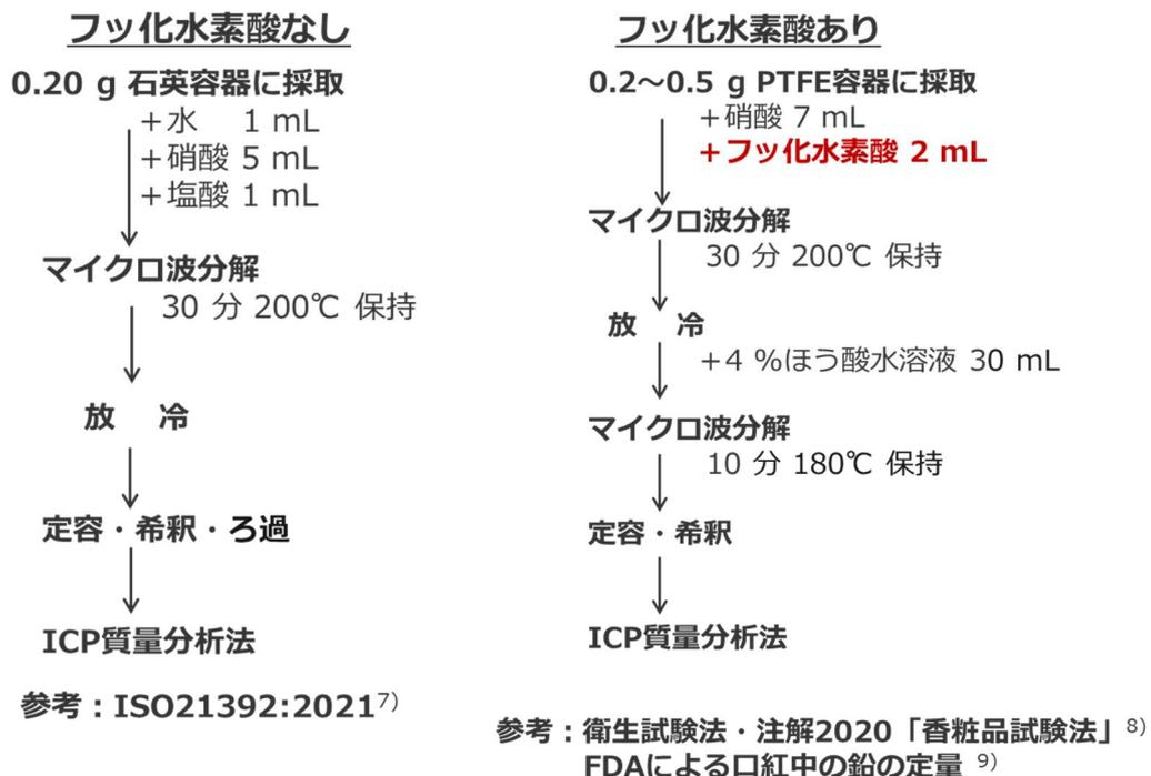
図-1 代表的なマイクロ波分解-ICP 質量分析法のフローチャート
