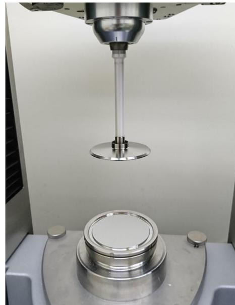
図-2 コーンプレート型粘度計の測定部
