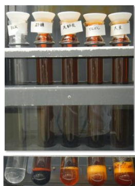
図-2 ヒートブロックによる湿式灰化中の様子
