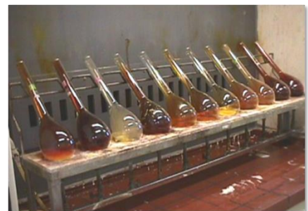
図-1 ケルダールフラスコによる 湿式灰化中の様子
