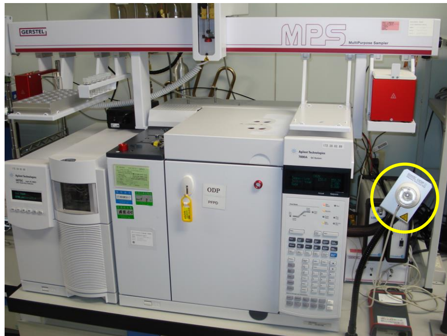
写真-1 におい嗅ぎ検出器付 GC/MS 丸の部分がロート型のにおい嗅ぎ検出器のポート
