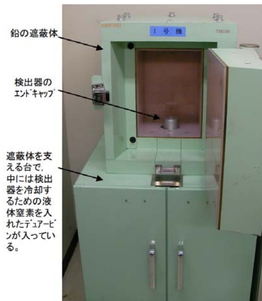
図-1 ゲルマニウム半導体検出器と鉛遮蔽体（上のドアを開いたところ）
